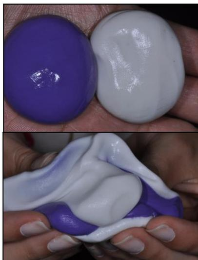
**Figura 3:** Porção de pasta base e porção de pasta catalisadora previamente dosadas e a homogeneização das massas.
